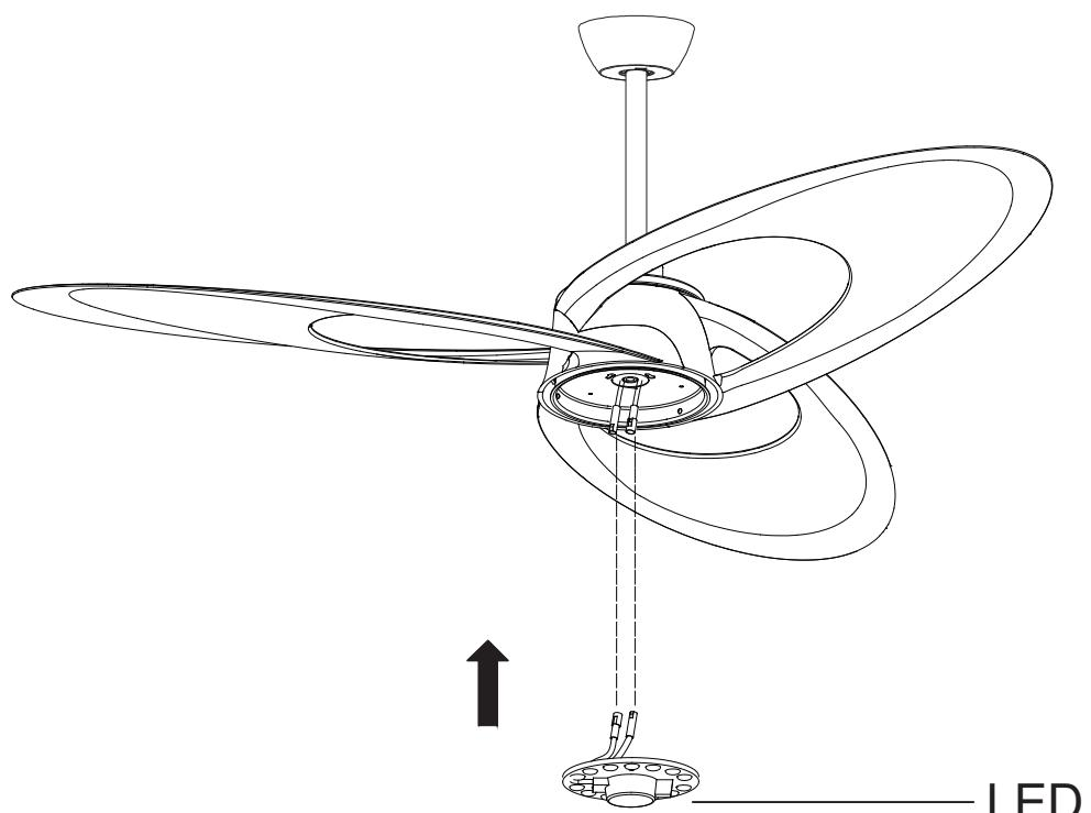
Inserte los conectores de los cables de la lámpara LED según el mismo color.
