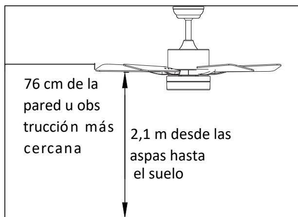
(Imagen orientativa. Ilustración genérica para la instalación)
